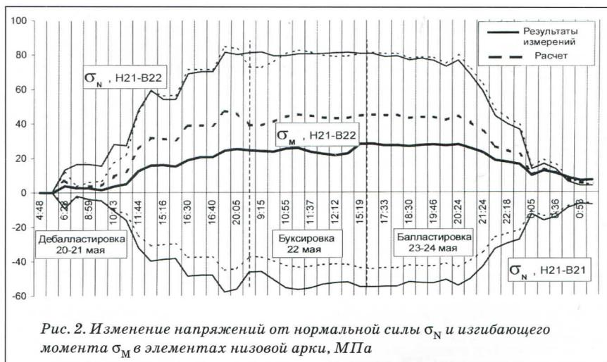
Рис. 2. Изменение напряжений от нормальной силы  $\sigma_N$  и изгибающего момента  $\sigma_M$  в элементах низовой арки, МПа
